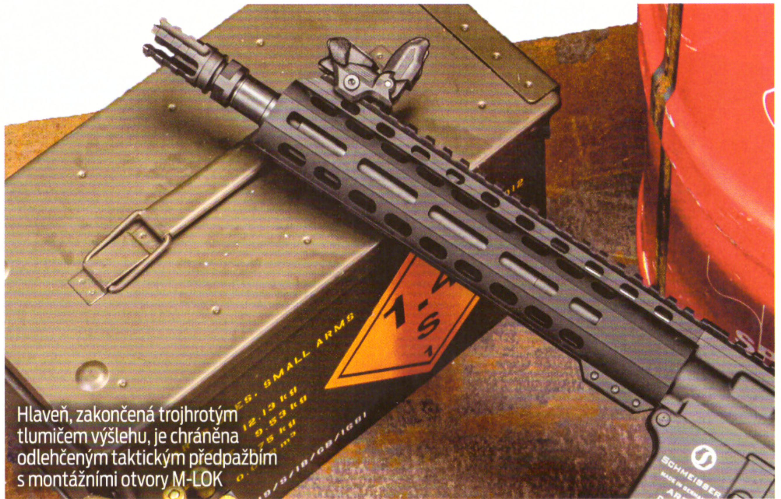
Odlehčené taktické předpažbí je ke zbraní uchyceno třemi šrouby a proti pootočení drženo bočními výstupky, které přiléhají k upperu zbraně
